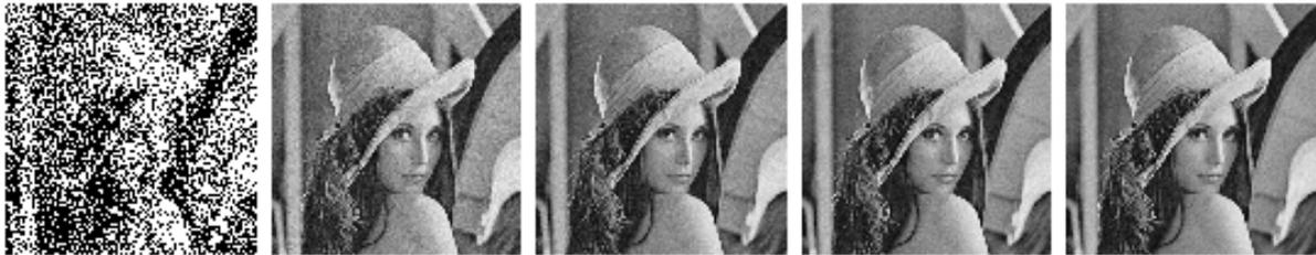
可见当仿真足够的步长，泊松编码器得到的脉冲叠加后几乎可以重构出原始图像。
